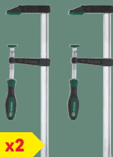
Ancho x profundidad de tensión: aprox. 350 x 80 mm. Fuerza de sujeción: máx. 2.700 N
